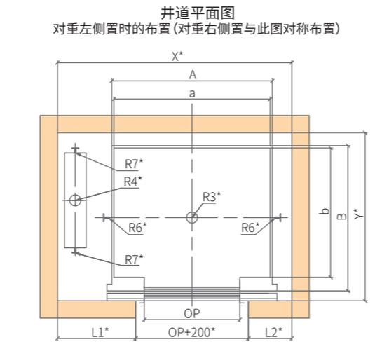
[注1] 井道前壁是砖墙结构时，层门门洞上方需设置高度不小于350mm、强度不小于C25的钢筋混凝土横梁。
