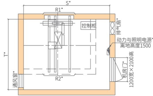
井道平面图 (开门形式:2S-2P, 左开门)
