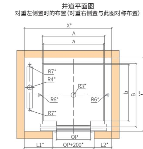
[注1] 井道前壁是砖墙结构时，层门门洞上方需设置高度不小于350mm、强度不小于C25的钢筋混凝土横梁。
