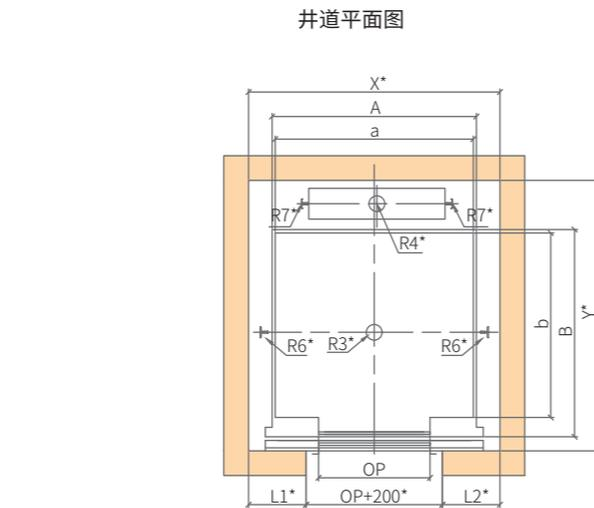
[注1] 井道前壁是砖墙结构时，层门洞上方需设置高度不小于350mm、强度不小于C25的钢筋混凝土横梁。
